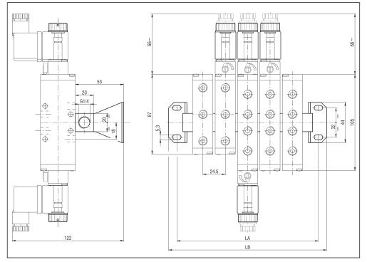
\*SUPPLY RAILS ARE SUPPLIED COMPLETE WITH HOLLOW SCREWS, SEALS AND FIXING BRACKETS P.S.: CAN BE MOUNTED ONLY SILENCERS SERIES **SS-01** (SEE THE HIDDEN SILENCERS ON PAGE 5.52)
